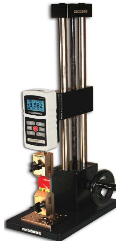
Imagen de soporte ES30 en una aplicación típica de ensayo en compresión con dinamómetro Serie 5
